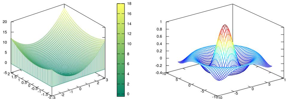
**Abbildung 11:** zwei Beispiele für die grafische Darstellung von Funktionen als Flächen im Raum. Links die Funktion  $f(x, y) = z = x + x^2 + y + y^2$ , rechts die 'Sombrero-Funktion'  $f(r) = \sin(r)/r$  mit  $r = \sqrt{x^2 + y^2}$ .
