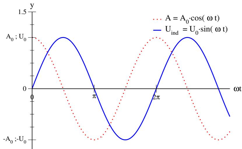
**Abbildung 8:** Leiterschleife im Magnetfeld: effektive Fläche  $A$  und induzierte Spannung  $U_{\text{ind}}$ . Die induzierte Fläche wird an den Stellen maximal, an denen die Änderung der effektiven Fläche maximal ist, also bei den Nulldurchgängen.
