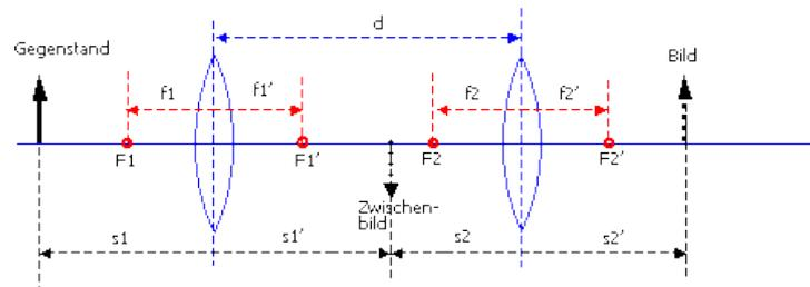
**Abbildung 1:** Konstruktion der Abbildung für ein Linsensystem.
